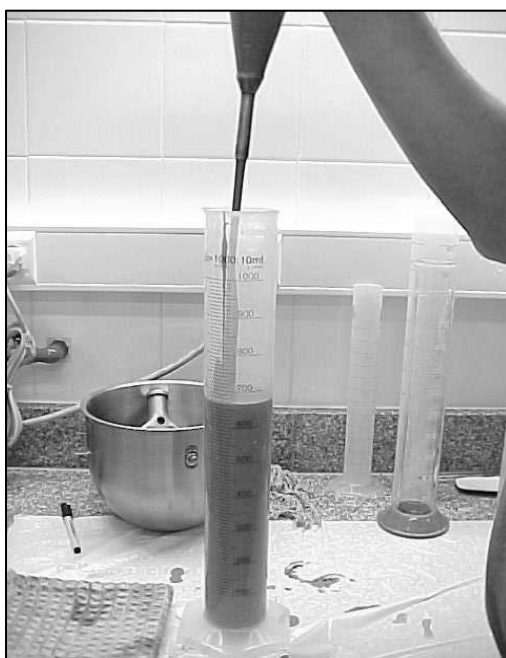
Foto 14- Ensayo de compatibilidad cemento – aditivo superfluidante.
