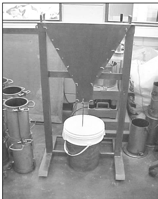
Foto 8 – V-Funnel para hormigones.
