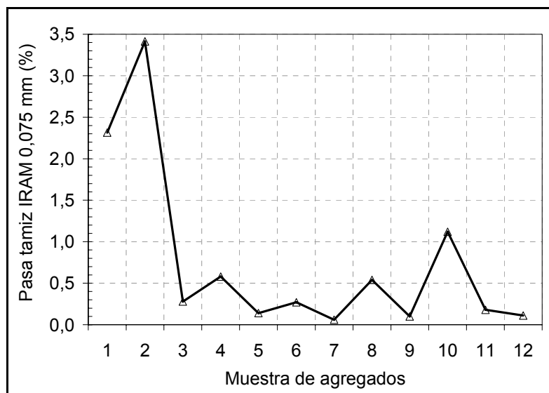
Figura 5.12 – Variación del porcentaje de material que pasa el tamiz IRAM de 75 µm para los AGR de la Serie A.
